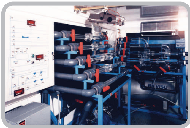
• Réalisation d'un banc didactique de visualisation d'écoulements / Didactic bench for flow visualization
